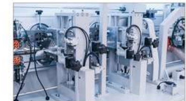
Duplo Acabamento Fino + Raspadores duplos
