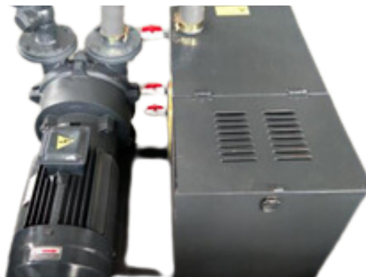
Vacuum pump 11KW
